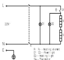
Heating element – нагревательный элемент
